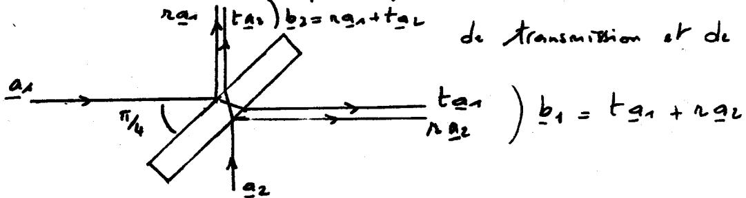
Les ondes réfléchies et transmises ont pour amplitudes  $b_1$  et  $b_2$
